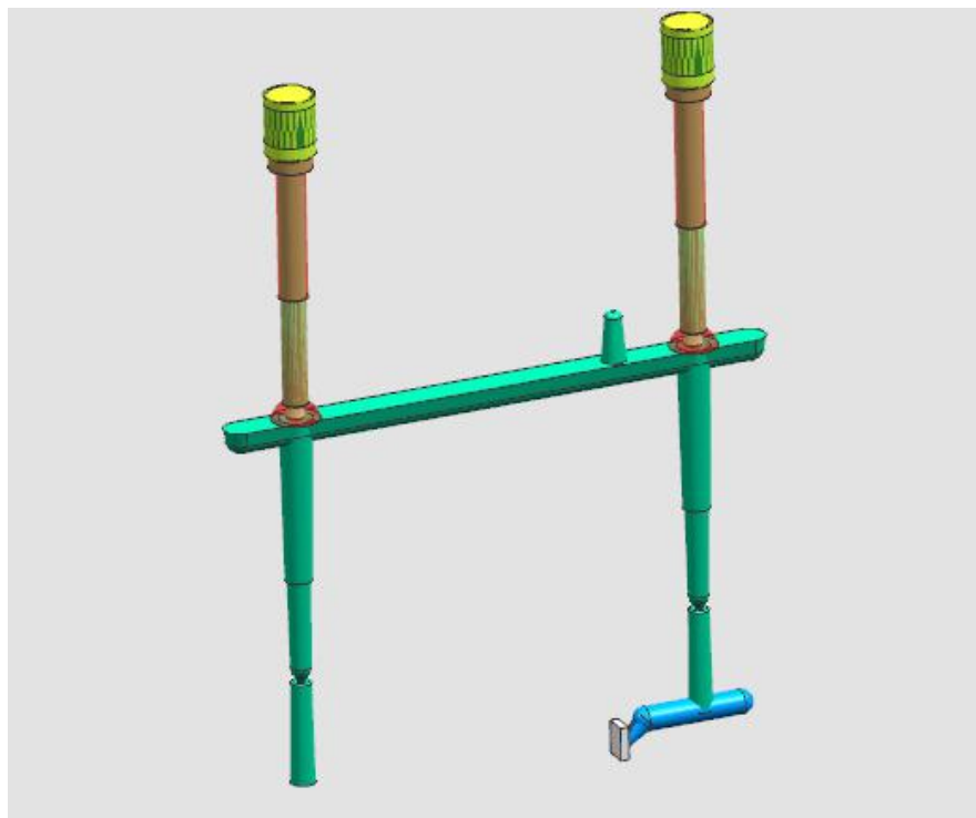
大水口转细水口进胶方式
